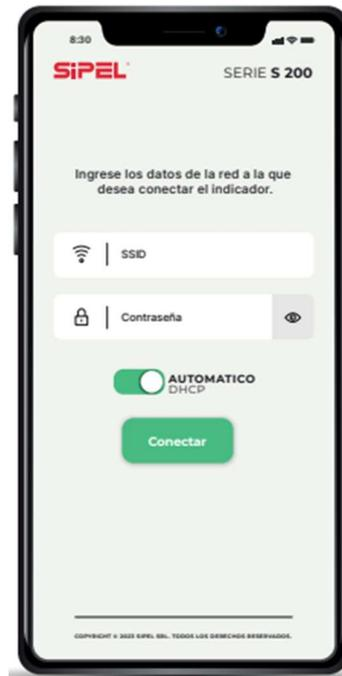
Por defecto, el indicador obtiene su dirección IP por DHCP. Si se desea conectar el equipo con una IP fija, deberá desactivarse la casilla de DHCP y completar los tres campos que aparecerán debajo.
